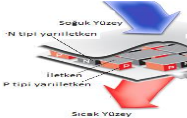
Şekil 1. Termoelektrik Modül (TEM) içyapısı
