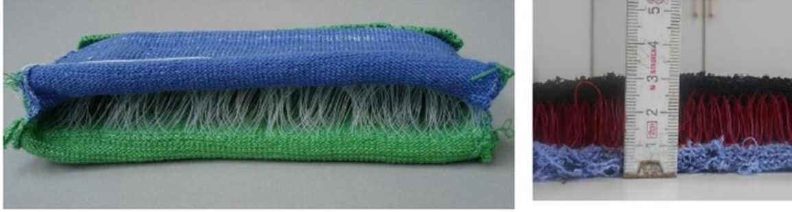
Şekil 4. Monofilament bağlantılı üç boyutlu kumaş (Ünal, 2014)
