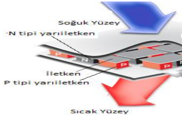
Şekil 1. Termoelektrik Modül (TEM) içyapısı
