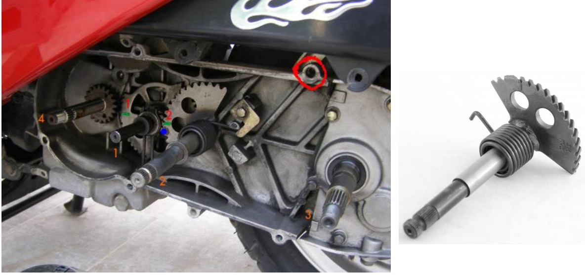
Şekil 4: Motosikletlerde kullanılan yarım ay dişli sistemi
