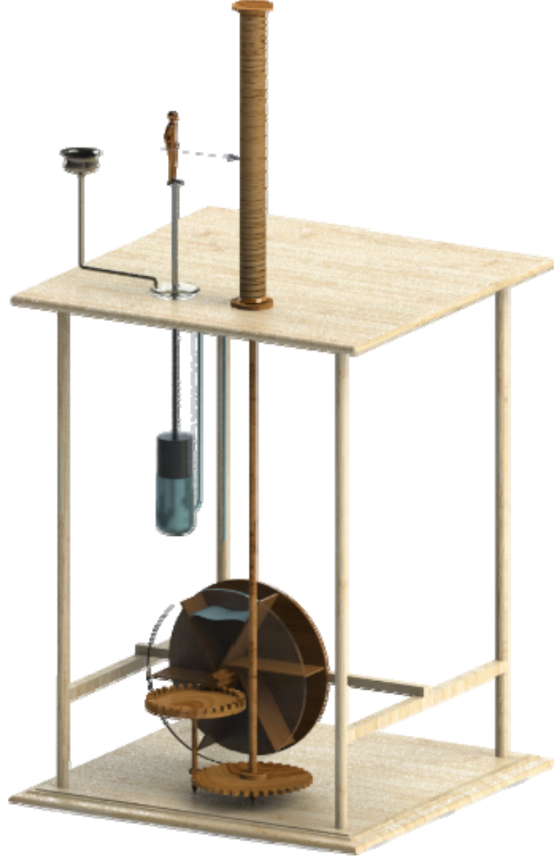
Şekil 5: Ktesibos Tarafından Geliştirilen Anıtsal Saatin 3D Modeli
