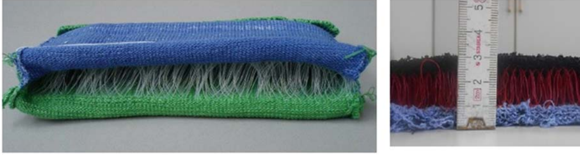
Şekil 4. Monofilament bağlantılı üç boyutlu kumaş (Ünal, 2014)
