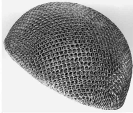
Şekil 7. Örme sandviç tekstil kompozitinden üretilen bisiklet kaskı (Mouritz ve ark., 1999)
